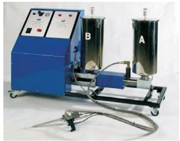
Basierend auf dem aktuellen Industriestandard hat das neue PAR5C Misch- und Dosiersystem einen „In-Line-Drive“ Mechanismus (ILD), der im Unterschied zu bisher üblichen pneumatischen Systemen ein kontrolliertes Fließverhalten während dem Dosiervorgang ermöglicht.
